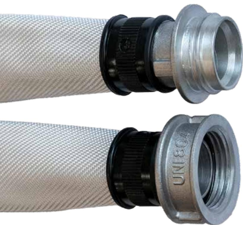
Il raccordo **AGILOk** è realizzato secondo la nuova norma **UNI 804:2020 forma C** per utilizzo su tubazioni prementi nei sistemi certificati CE a norma EN 671-2.
