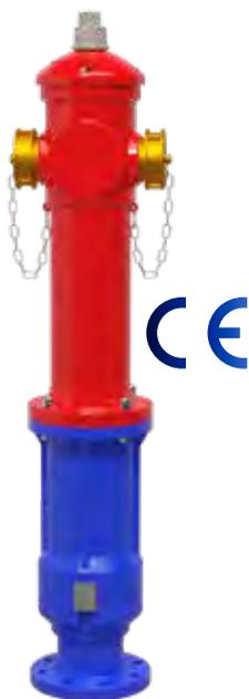
**Idrante soprasuolo mod. EUR, per acqua potabile, a norma UNI EN 14384 in ghisa DN 80 - DN 100 - tipo a secco con scarico automatico antigelo**
