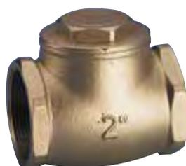
Valvola ritegno in ottone a Clapet tenuta gomma. Attacco filettato femmina GAS ISO 228, uscita filettata femmina GAS ISO 228.
