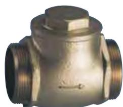
Valvola ritegno in ottone a Clapet tenuta gomma. Attacco filettato maschio GAS ISO 228, uscita filettata maschio GAS ISO 228.
