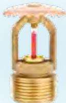
Sprinkler Upright 3/4" approvato CE UL/FM, attacco 3/4", orifizio 17/32" (14mm), fattore K=115.
