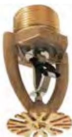
Sprinkler Pendent E.S.F.R. a grande portata per MAGAZZINO, risposta rapida approvato UL/FM. Attacco filettato 3/4" BSPT - 1" BSPT, per installazione verso il basso in impianti a umido, pressione massima d'esercizio 12 bar.
