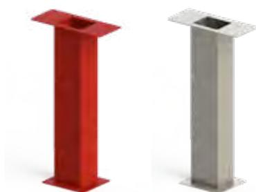
Piantana in acciaio al carbonio verniciato in poliestere rosso RAL 3000 o in acciaio INOX 304 non verniciato. Altezza da terra 75 cm. Scatolato 200x120mm. Piastra di base 250x200. Vedere tabella per dimensione piastra superiore
