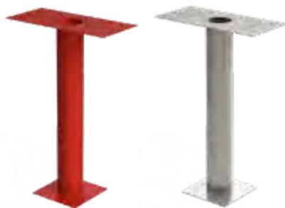
Piantana in acciaio al carbonio verniciato in poliestere rosso RAL 3000 o in acciaio INOX 304 non verniciato. Altezza da terra 75 cm. Tubo D. 90mm per DN 45 e tubo 110mm per DN 70
