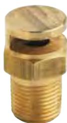
Ugello aperto a lama in ottone. Attacco 1/2", per installazione orizzontale o verticale in impianti a diluvio (applicazioni tipiche: cortine d'acqua, protezione vetrate e cisterne). Pressione max di lavoro 12 bar.
