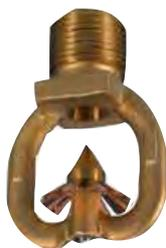
Ugello aperto a cono pieno 1/2" in ottone. Attacco 1/2", per installazione in impianti a diluvio (applicazioni tipiche: aree di stoccaggio, magazzini contenenti materiali infiammabili, hangar, protezione cisterne).
