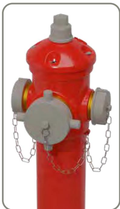
**Il nuovo coperchio per i modelli DN 80 e DN 100** è stato progettato in modo da permettere, pur salvaguardando la parte estetica e funzionale, la manovra solo con l'innesto della specifica chiave pentagonale, normalmente in possesso solo del VVF e del personale preposto all'intervento in caso di incendio. Il design della sagoma permette, ove richiesto, l'alloggiamento del **dispositivo di bloccaggio dell'apertura in funzione antivandalo art.702**.
