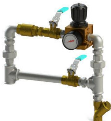
I dispositivi di mantenimento pressione aria, ns art. 908, sono articoli realizzati per controllare e regolare la pressione dell'aria del sistema, quando si utilizzano valvole di allarme a secco e preallarme (o a diluvio ad attuazione pneumatica) garantendo, tramite un compressore, un'alimentazione permanente di aria rispettando inoltre i valori di pressione raccomandati, come previsto dalla norma:
