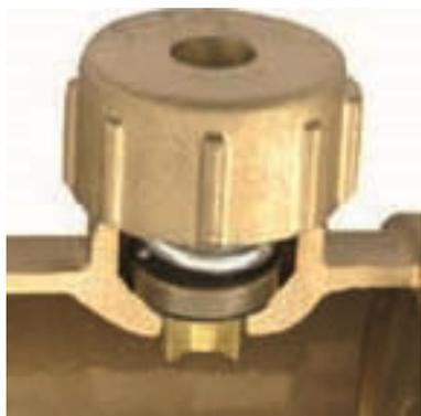
La norma UNI 10779 richiede la presenza di almeno una valvola (tarata a 1,2 MPa) per sfogare eventuali eccessi di pressione dalla motopompa dei Vigili del fuoco. I gruppi autopompa di mandata "ALL IN ONE A SECCO" dispongono di serie di n. 1 valvola principale sul corpo (PARTE A). Inoltre, nei collettori esterni (PARTE B) è presente un'ulteriore valvola ausiliaria (identica a quella principale) per ogni bocca di immissione.
