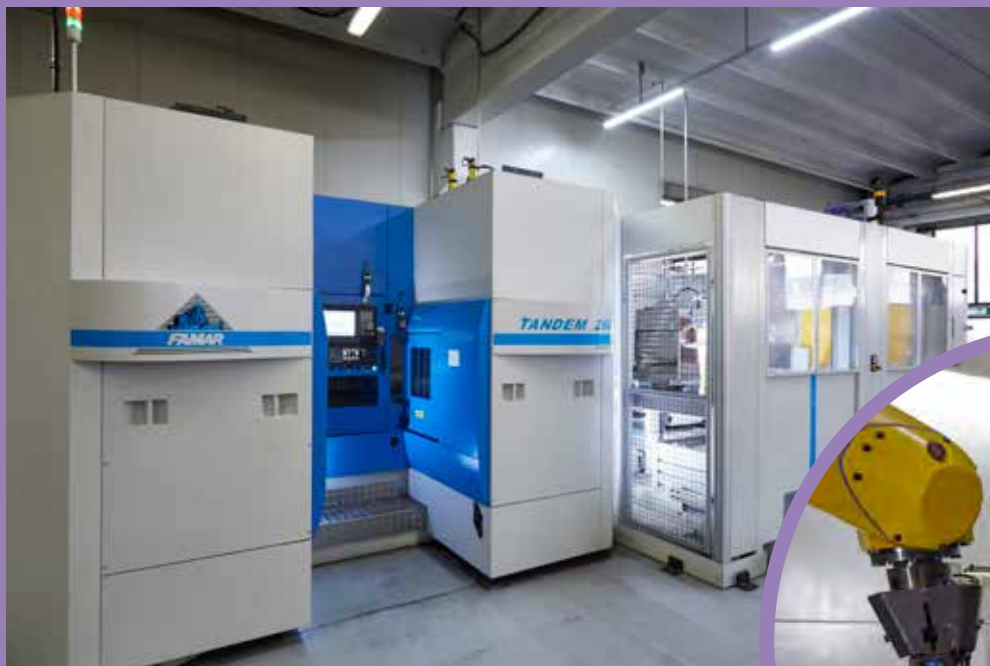
transfer robotizzato per la lavorazione dei raccordi
