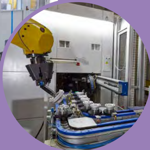
transfer robotizzato per la lavorazione dei raccordi
